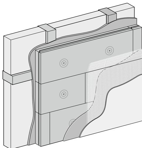
Holzfaserdämmplatte für die Innendämmung von Fachwerkhäusern und allen anderen Altbauten. Die ClayTec HFD Innendämmplatte wird flächig in eine Lehmputz-Ausgleichslage geklebt oder mit Lehmklebe- und Armiermörtel befestigt. Die weichen Platten entkoppeln Verformungen der Konstruktion vom Innenputz. Sie sind preisgünstig und für viele Außenwandarten geeignet.
