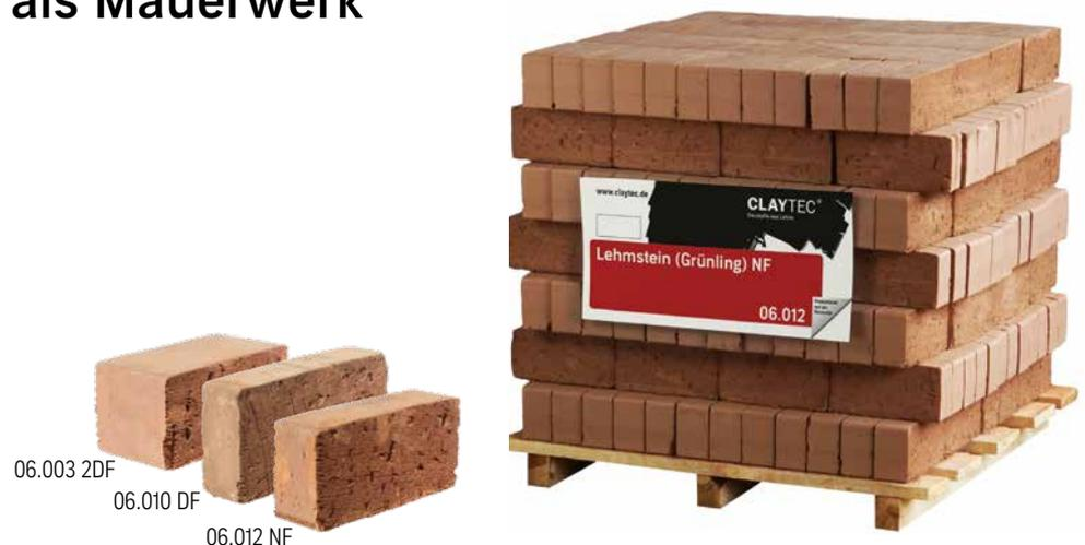
Schwere stranggepresste Lehmsteine der Anwendungs-klasse II, für den Trockenbau und Innenmauerwerk. Der Lehmstein 1900 DF ist ein Vollstein. Wegen seiner geringen Höhe wird er meist für Deckenfüllungen, -auflagen und für Stapelschalen im Trockenbau verwendet. Lehmstein 1900 NF wird auch für Mauerwerk verwendet. Lehmstein 1600 2DF ist ein Lochstein. Als Mörtel ist Lehm-Mauermörtel schwer geeignet.
