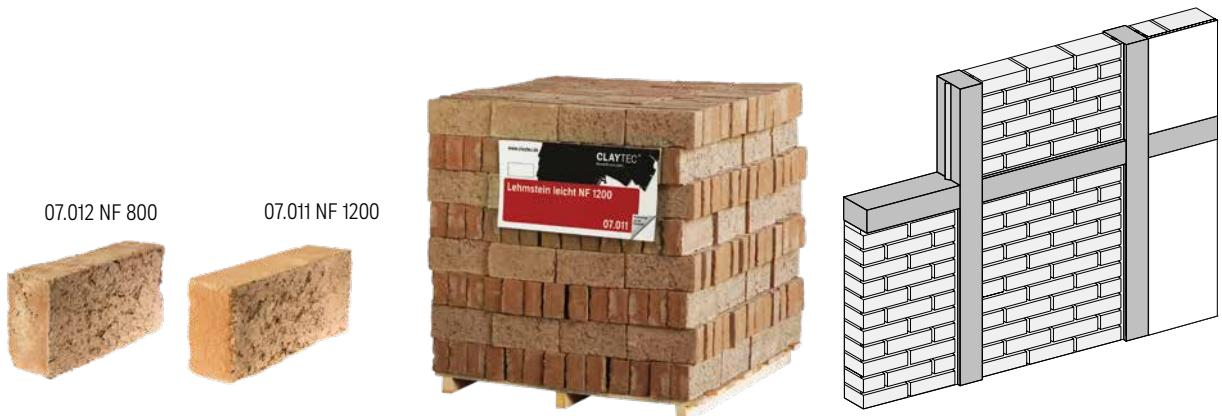
Leichter formgeschlagener Lehmstein der Anwendungsklasse Ia (= zugelassen für Fachwerkausmauerung) im Format NF. Die Zusammensetzung und Herstellungstechnik machen ihn sehr resistent gegen Nässe und Frost. Das althergebrachte Normalformat (NF) liegt gut in der Hand, die Größe ist für Fachwerk genau richtig. Der Lehmstein 1200 NF lässt sich bestens schlagen und schneiden. Als Mörtel ist Lehm-Mauermörtel leicht geeignet, für den Verputz Kalk-Grundputz Haar grob.
