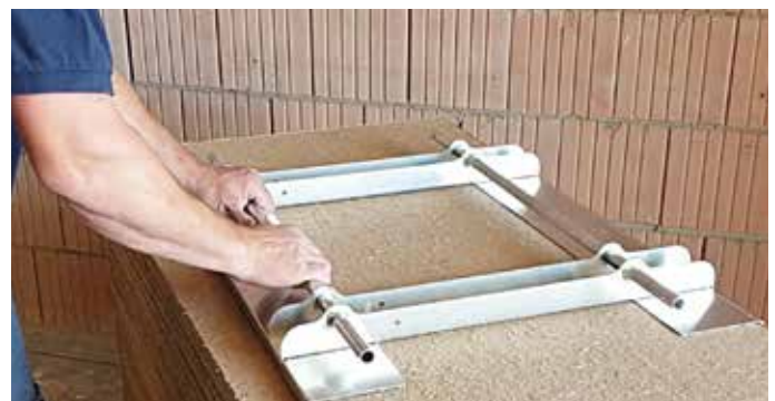
Transporthilfe für Lehmbauplatten
